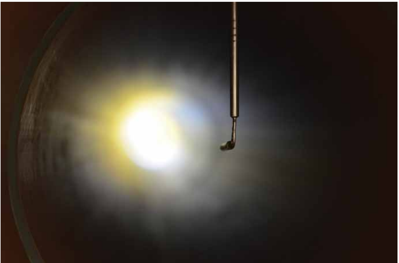
Sonda pomiarowa ciśnienia w kanale dolotowym do dmuchawy DP1.12 // Pressure tube placed within an inlet channel of blower DP1.12
