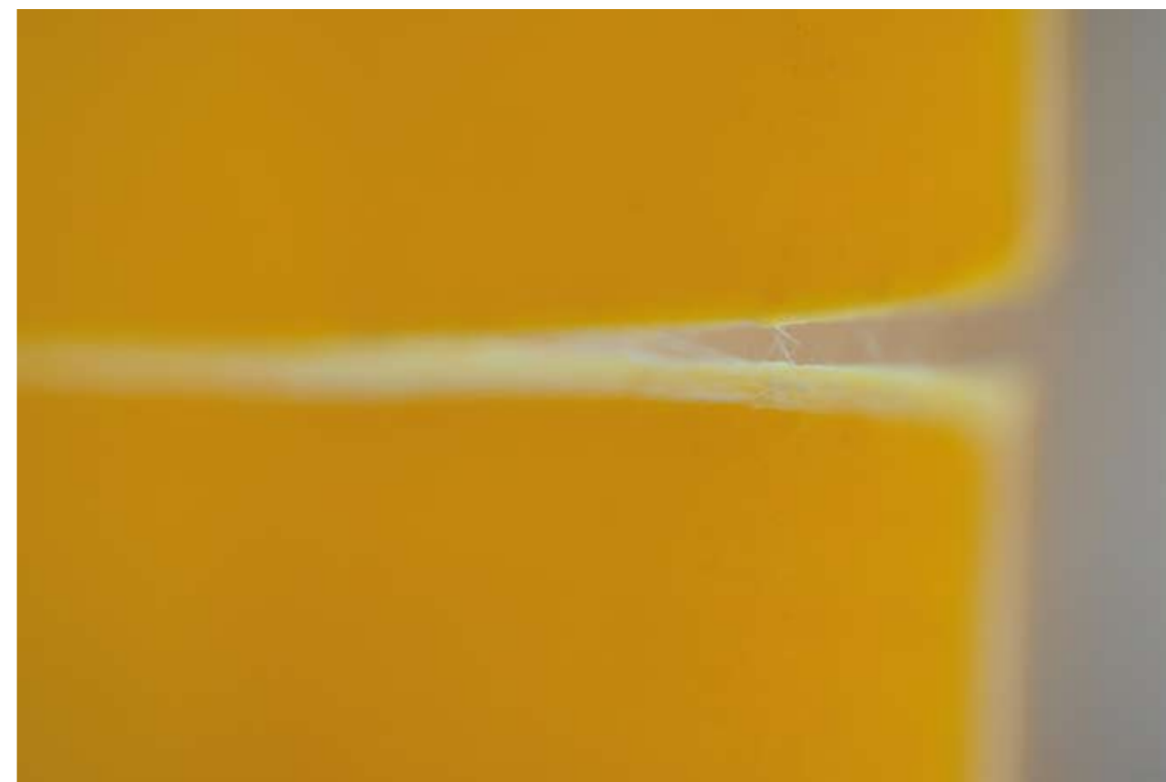
Mostkowanie, Laboratorium analizy zniszczenia struktur kompozytowych, Wydział Mechaniczny PK // Bridging, Laboratory of failure analysis of composite structures, Faculty of Mechanical Engineering, CUT
